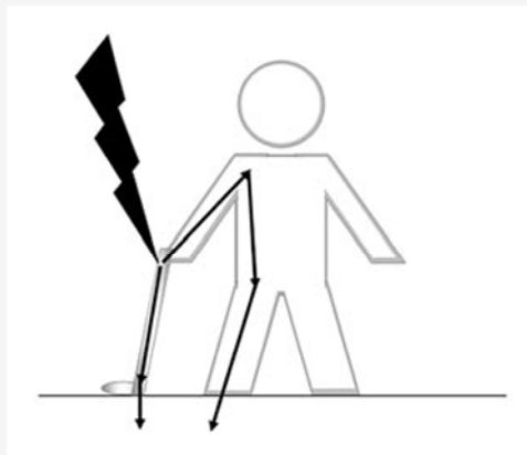
Abb.2 ▲ Kontakteffekt („contact voltage“) mit Blitzschlag in ein Objekt, das vom Opfer berührt wird (z. B. Golfschläger)
